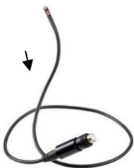
Af. 50: Sonda Wöhler VE 400, Ø 5,5 mm, botón para omschakelen del kijkrichting marcado con un pijltje.
